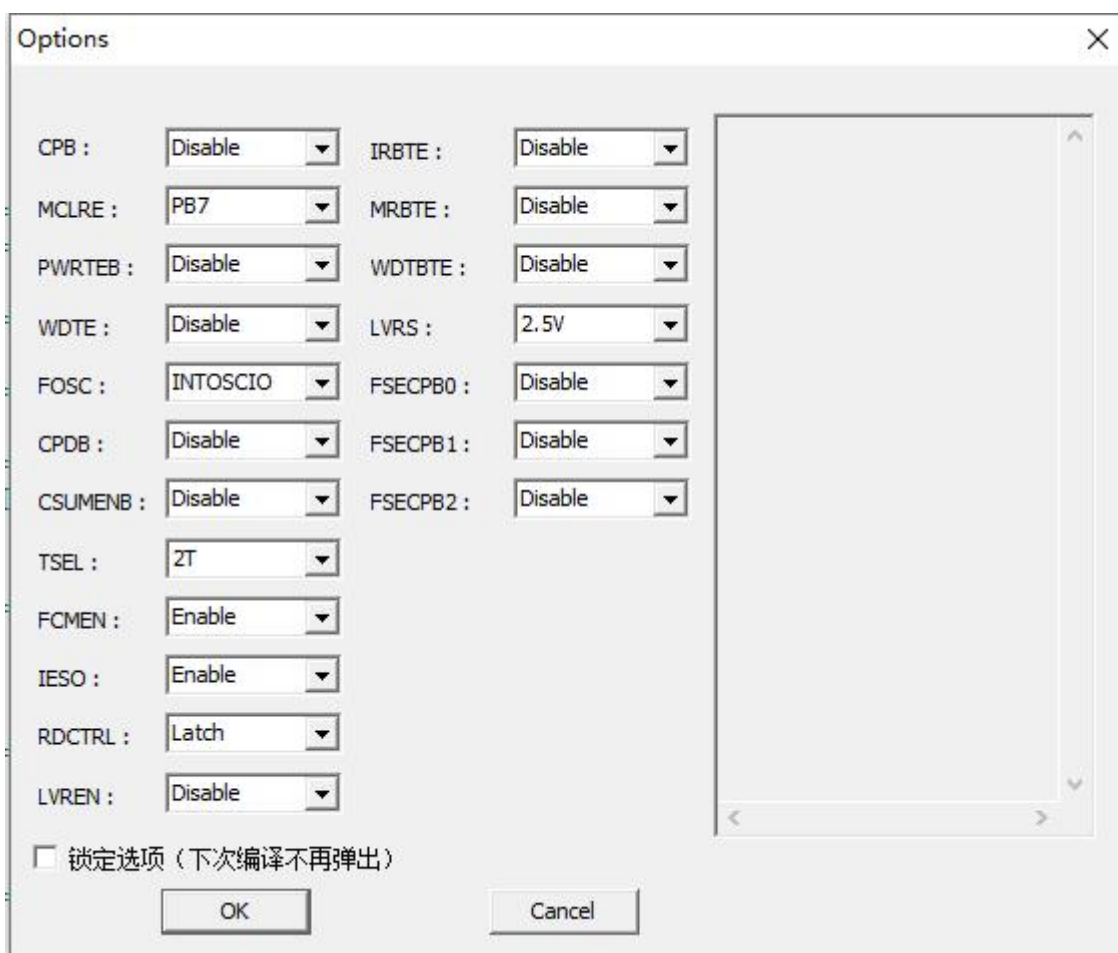
图 16-1 由 IDE 设置的初始化配置寄存器
